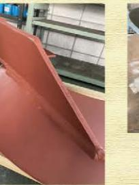
鋭角度(45度)の隅肉溶接で、脚長15mm、その熱で倒れる(変形する)分を矯正、固定、補強しながら溶接していく。
