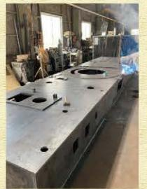
事前に組み合わせ手順などをシミュレーションすることで、精度のよい寸法、角度、平面度を保証していく。
