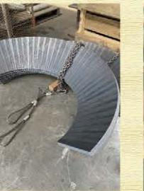
曲げによる伸びなどを考慮して、R曲げを行っていく。曲げ面を三次元に仕上げていく匠の技。
