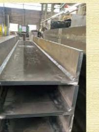
写真のような溶接を行うと、湾曲だけでなく、スネーク状に歪が発生、それを匠の技で現物合わせで圧をかけながら歪を矯正していく。
