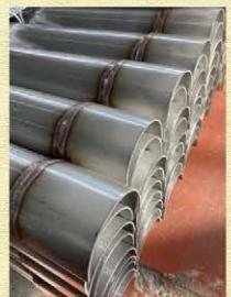
R曲げ加工により、現物に合わせて溶接する現合技術に優れている。
